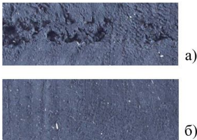
Рис.2. Фотографии поперечных сечений переработанной резиновой крошки без воздействия ультразвука (а) и с его применением (б)
